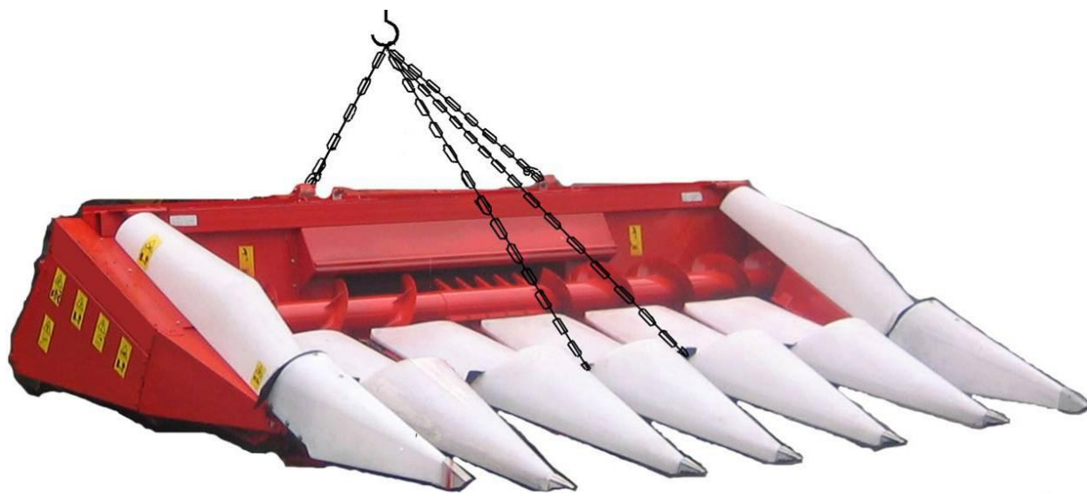
Рисунок 5.1 – Схема строповки жатки
